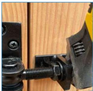
Durch Lösen und Anziehen der großen Schrauben können Sie die Tür justieren.
