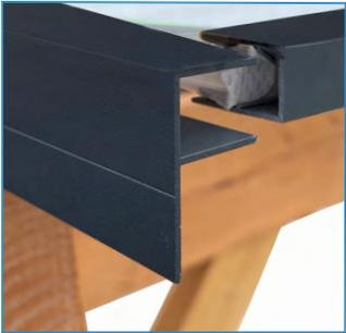
2. Sie können das Aluminium-F-Abschlussprofil mit der langen Kante nach unten anbringen. Auf diese Weise wird das Profil hauptsächlich an den freien Seiten einer Konstruktion verwendet.
