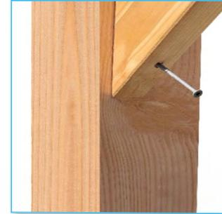
Zum Schluss können Sie die Streben montieren, eine an den äußeren Pfosten und ggf. zwei an den inneren Pfosten. Verwenden Sie dazu die 120 x 5 mm AR-Schrauben.
