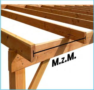
Jetzt, wo die Douglasienholz Konstruktion steht, können Sie mit dem Polycarbonat-Stegplattendach fortfahren. Das Wichtigste dabei ist, dass der Abstand zwischen den Balken (Mitte zu Mitte Maß) 2 cm mehr beträgt als die Breite Ihrer Stegplatte. Wenn Sie zum Beispiel eine Polycarbonat-Stegplatte mit einer Breite von 98 cm (unser Standardmaß) haben, beträgt der Abstand (Mitte zu Mitte Maß) zwischen den Balken 100 cm.
