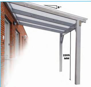
Die obigen Abmessungen gehen von einer Durchgangshöhe von 2205 mm aus. Dies ist natürlich keine Voraussetzung. Wenn es Ihnen lieber ist, den Wandbalken 100 mm niedriger zu befestigen, müssen Sie an der Unterseite der Pfosten 100 mm abziehen, um eine Neigung von 8° zu einzuhalten.
