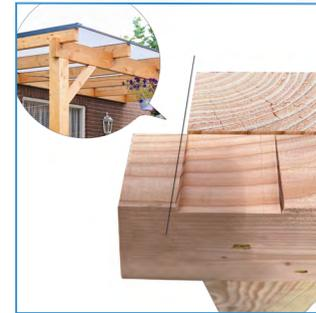
Achten Sie beim Verschrauben des Querträgers (mit den eingefrästen Aussparungen nach oben) an den äußeren Pfosten darauf, dass die Aussparung an der Außenseite bündig mit der Außenseite des Pfostens ist. Dies ist ein Beispiel, bei dem Sie den größten Abstand zwischen den Pfosten haben. Die Position der Pfosten in der Breite hängt von Ihrem Geschmack ab. Der maximale Abstand zwischen 2 Pfosten beträgt 4 Meter, der Querbalken sollte nie mehr als 70 Zentimeter überhängen.
